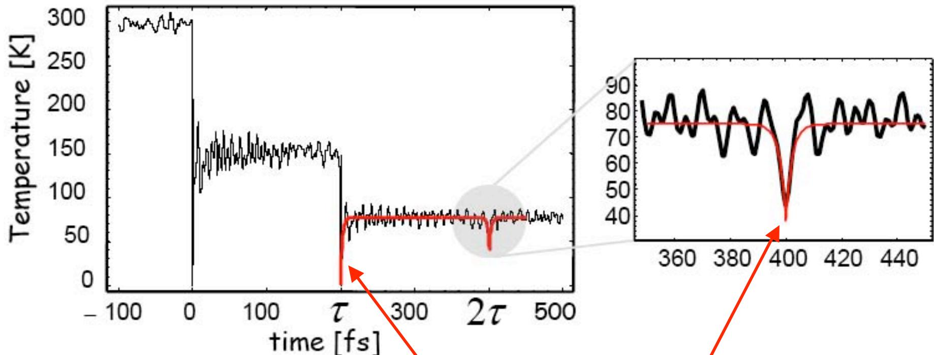
$$T(t) \approx \frac{T_0}{2} \left( 1 - C_{TT}(t - \tau) - \frac{1}{2} C_{TT}(|t - 2\tau|) \right)$$
